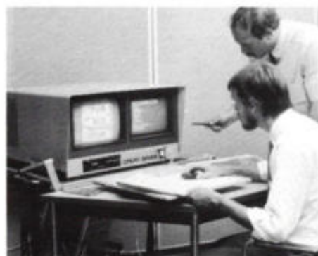
Mobiele Calay computer voor het ontwerpen van printplaten, zoals gebruikt door El-Contro-nic.
