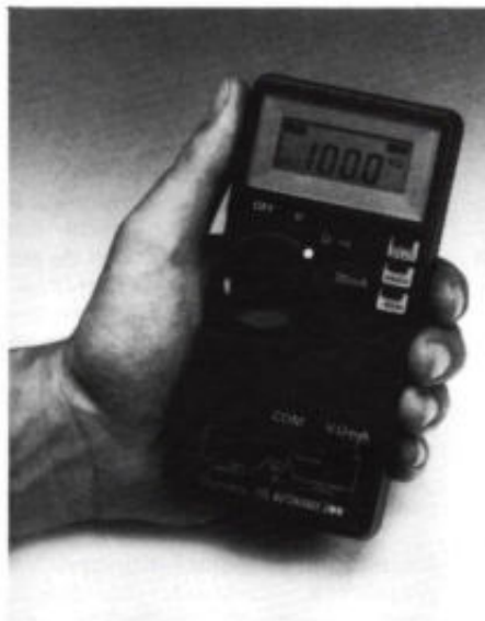
Digitale multimeter Dynatek 775 met automatische bereikselectie en ingebouwde temperatuurmeter.
